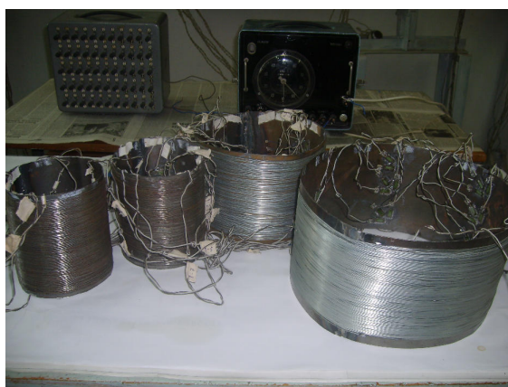
Рисунок 1– Фрагмент цилиндрической оболочки, подготовленный к испытаниям
